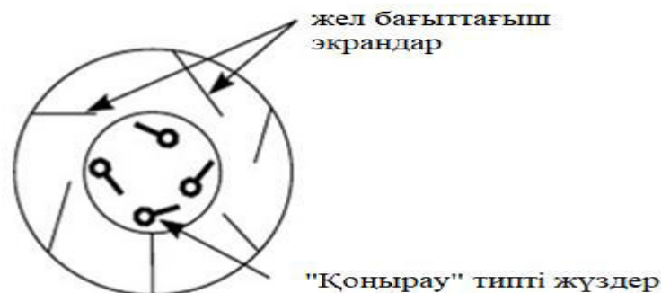
Сурет - 2.2. Жел бағыттауыш экрандармен және «Қоңырау» типті жүздермен істелінген жел генераторының құрылымы
