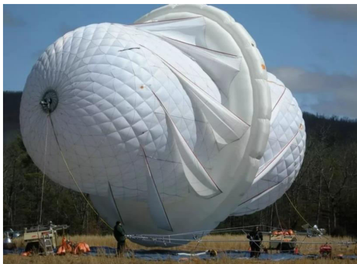
Сурет - 1.2. Ұшатын жел генераторы (Magenn Power Air Rotor System)
